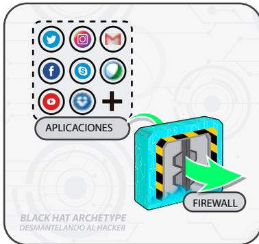
Paloalto permite monitorear el tráfico de red entrante y saliente, también decidir si permite o bloquea el tráfico específico en función de un conjunto definido de reglas de seguridad. Paloalto establece una barrera entre las redes internas protegidas y controladas en las que se puede confiar y redes externas que no son de confianza, como Internet.
